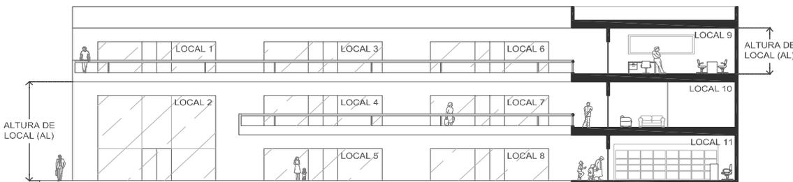
El esquema muestra las cotas de Altura de Local (AL) en un local de dos un niveles y otro de uno
